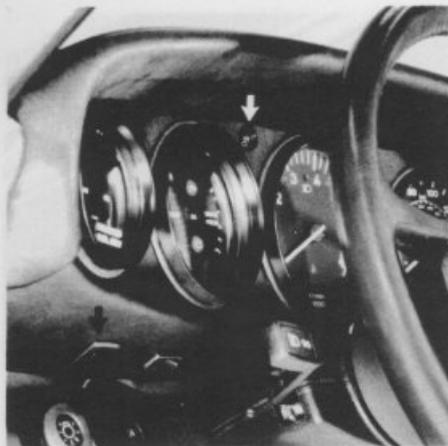
2. Actionner le commutateur à bascule jusqu'à ce que la lampe témoin s'éteigne. (position finale).
