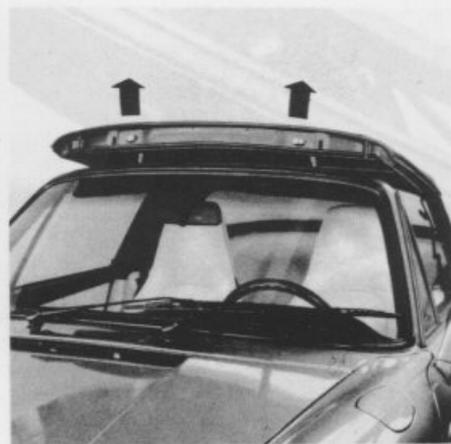
Commande électrique de la capote avec verrouillage électrique
