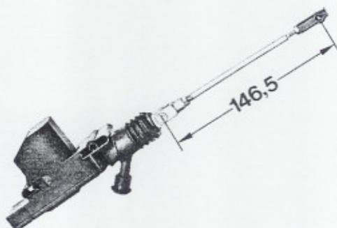
2. Clipser la barre de liaison avec l'élément de blocage sur la serrure de la porte. Il est absolument nécessaire de retenir lors du clipsage de manière à éviter une déformation de la plaque de base de la serrure.
