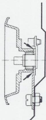
2. Lors du montage de l'équerre de réglage pour l'enjoliveur de porte, sur la porte à l'avant, il faut veiller à ce que la plage de réglage de l'enjoliveur de porte ne soit pas agrandie en cas de torsion de l'équerre de réglage.
