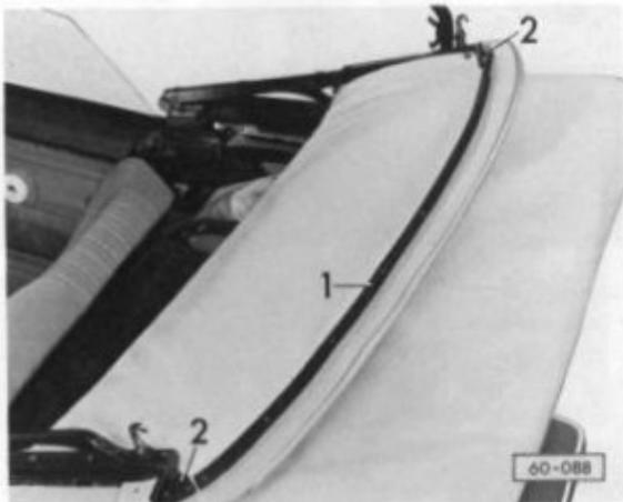
Déposer la glace AR. Debrancher le câble de dégivrage de glace AR et le retirer du joint de glace. Détacher la garniture de capote sur tout le pourtour de cadre de glace AR en soulevant les agrafes métalliques.
