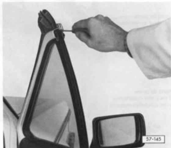
**Fig. 4 Rail de guidage: dépose**
