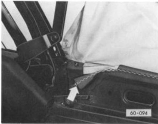
– Dévisser le câble-tendeur sur le bloc-tendeur. Lors du dévissage, freiner le câble-tendeur avec une clé à fourche de 4 mm pour l'empêcher de tourner.
