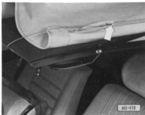
– Introduire le câble-tendeur dans la garniture de capote à l'aide d'un fil métallique.
