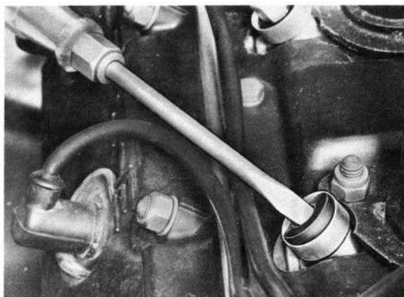
3. Si la garniture de caoutchouc reste dans la douille de maintien, la chasser avec un tournevis approprié.
