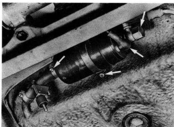
3. Visser une nouvelle soupape de retenue avec une nouvelle bague d'étanchéité.
