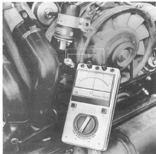
Si les valeurs de mesure sont correctes, réparer le câble entre la fiche et l'appareil de commande HKZ ou le remplacer.
