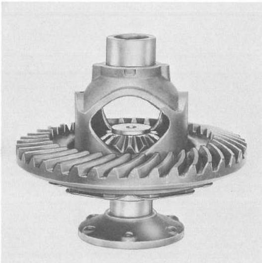
6. Emmancher l'axe de satellites dans le sens correct et le freiner avec une goupille à taille hélicoïdale.
