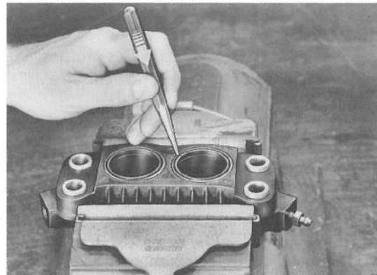
4. Sortir les segments d'étanchéité avec une barre en matière plastique.
