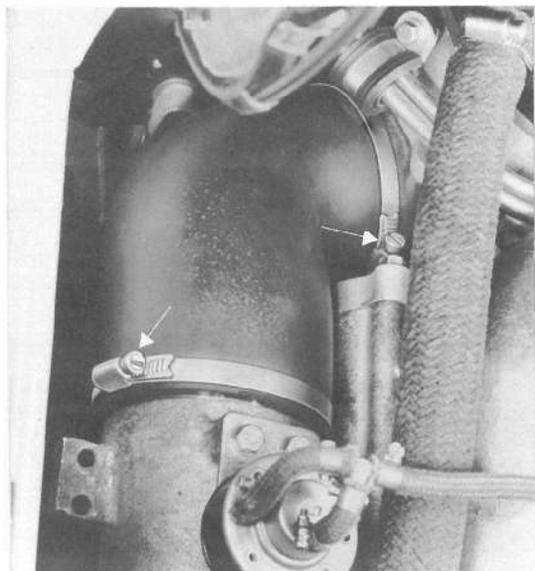
3. Dévisser la vis six pans du support et les vis six pans de la console de pompe.
