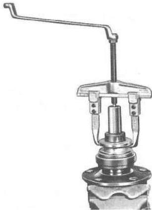
3. Chauffer le bras oscillant (plaque chauffante, four). Chasser la cuvette du roulement hors du bras oscillant.
