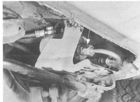
2. Brancher le manomètre de l'outil spécial P 378 entre la conduite d'aspiration de la pompe arrière, en liaison avec l'outil spécial P 9114.
