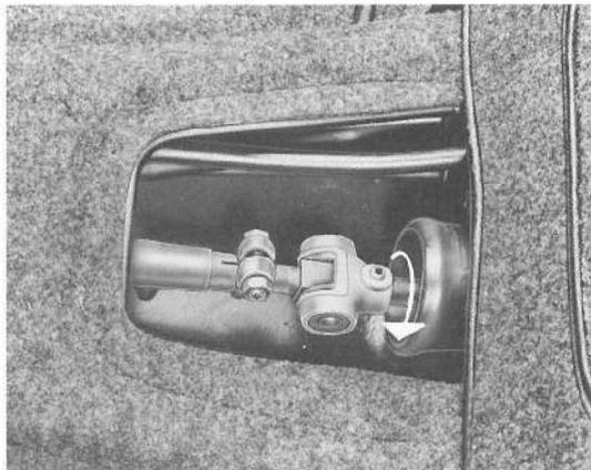
2. Amener le levier de commande en position de point mort de telle sorte que la partie inférieure du levier soit verticale et contre la butée à droite (3e et 4e vitesse).
